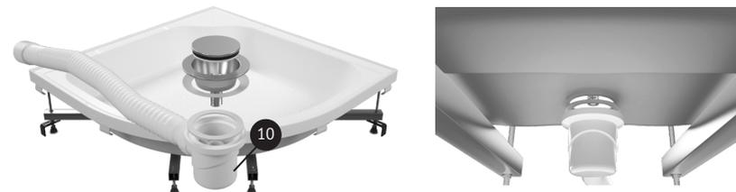
3.2 Подсоедините гофрированный шланг от сифона к сливному отверстию канализации.
